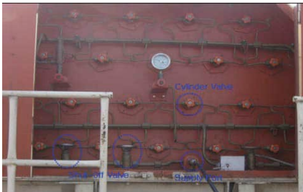
<그림 10> 시료채취 도중 폭발된 튜브트레일러
